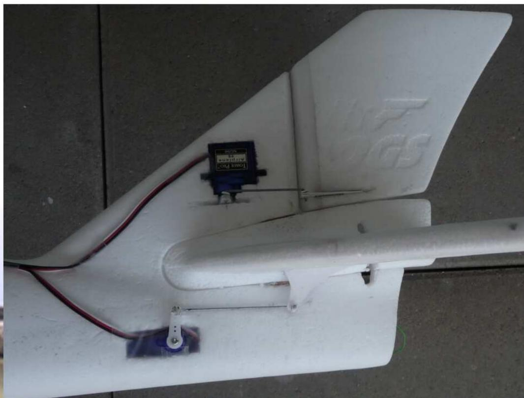
**Photo R.2 – Disposition du système de commandes**
