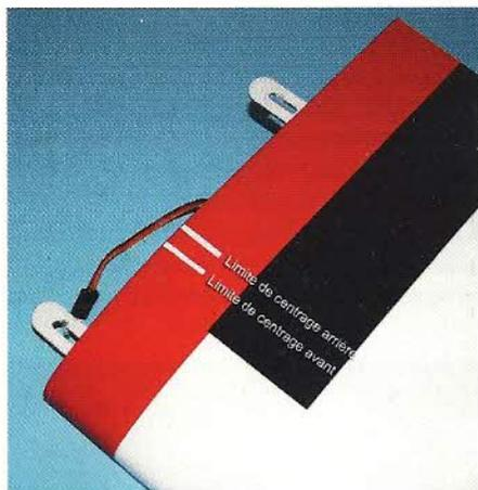
De petites bandes d'adhésif collées à l'intrados ou à l'extrados permettent de "sentir" les limites de centrage quand on soulève l'avion sur les doigts.
