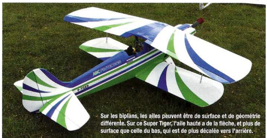
Sur les biplans, les ailes peuvent être de surface et de géométrie différente. Sur ce Super Tiger, l'aile haute a de la flèche, et plus de surface que celle du bas, qui est de plus décalée vers l'arrière.
