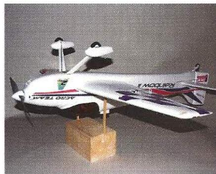
L'avion est posé sur un support d'équilibrage au niveau des marques de position du centre de gravité. Il est plus facile de le faire en retournant l'avion quand on a une aile basse.
