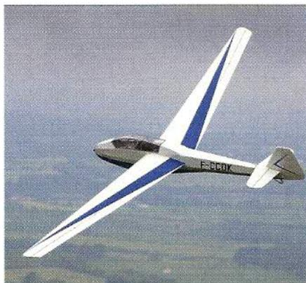
Cas typique d'aile en flèche inverse sur ce Bergfalke : le centrage reporté sur l'emplanture va être très proche du bord d'attaque, et c'est normal !
