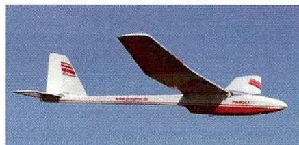
L'Amigo IV de Graupner est typique de la configuration à aile à profil creux et stab porteur. Il est centré à 55 % de la corde de l'aile.
