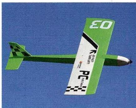
Les racers ont un tas de particularités : un volume de stab obtenu plus par le bras de levier que par la surface, un calage extrêmement faible adapté aux très hautes vitesses, et un centrage avant pour les rendre très stables aux plus hautes vitesses. Ce Petit Chelem de seulement 90 cm vole à 240 km/h et plus...
