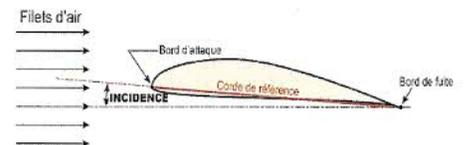
L'incidence est liée à la direction des filets d'air.
