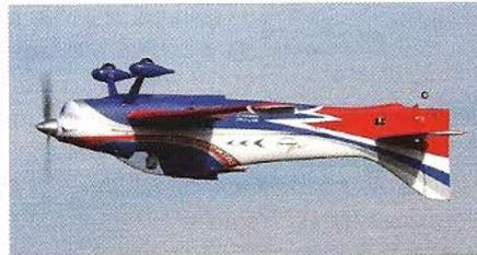
Les «Multis» de voltige type F3A modernes ont un calage faible et un fuselage dessiné pour qu'il semble parfaitement horizontal sur le ventre comme sur le dos.
