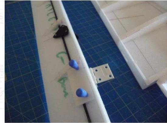
*Le système de fixation entre aile inter/exter*
